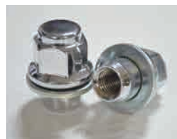
純正採用の「平座ナット」対応ホール形状
