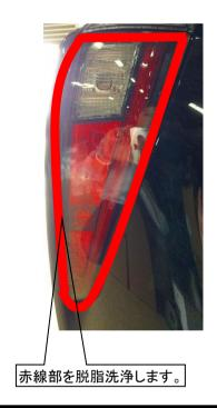
2 (1) ①本体を車両に装着完成図の位置を参考に左右のバランスを確認しながら仮付けし、取付け位置を確認します。
