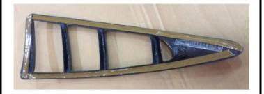
(1) ①本体裏面の③両面テープ貼付け面を600番程度 の紙ヤスリで軽く荒し、脱脂処理後、④PACプライ マー(赤)を使用し下処理を行います。
